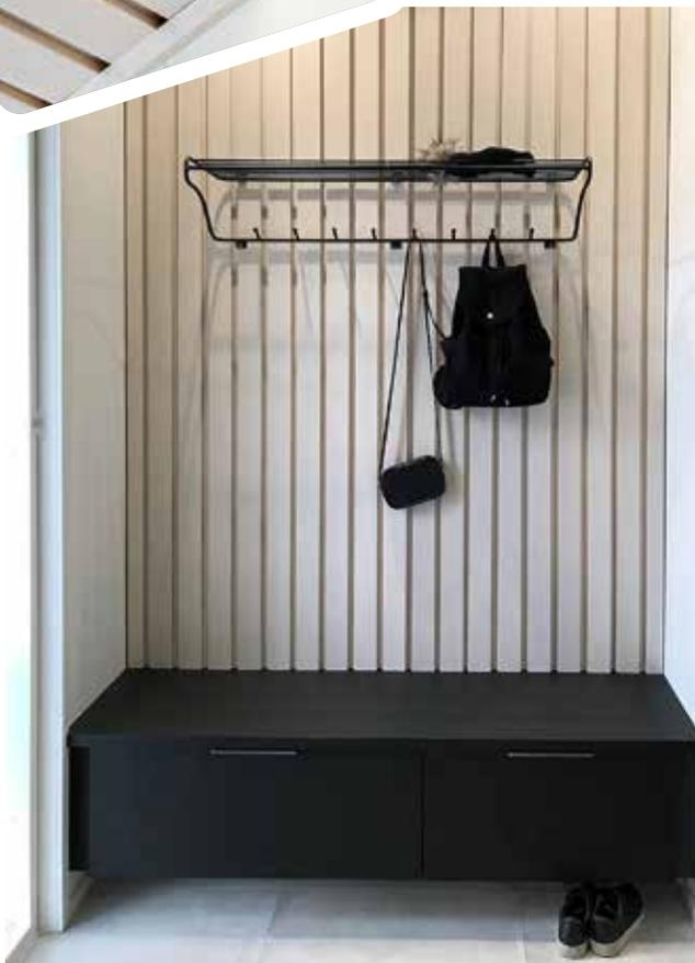
Die besonders tief genutete Form der VALO-Innenraum Profile erzeugt eine äußerst ansprechende Leistenoptik ohne offene Fugen in der Fläche. Die Spundung über die gesamte Längsseite ermöglicht eine schnelle und präzise Montage.
